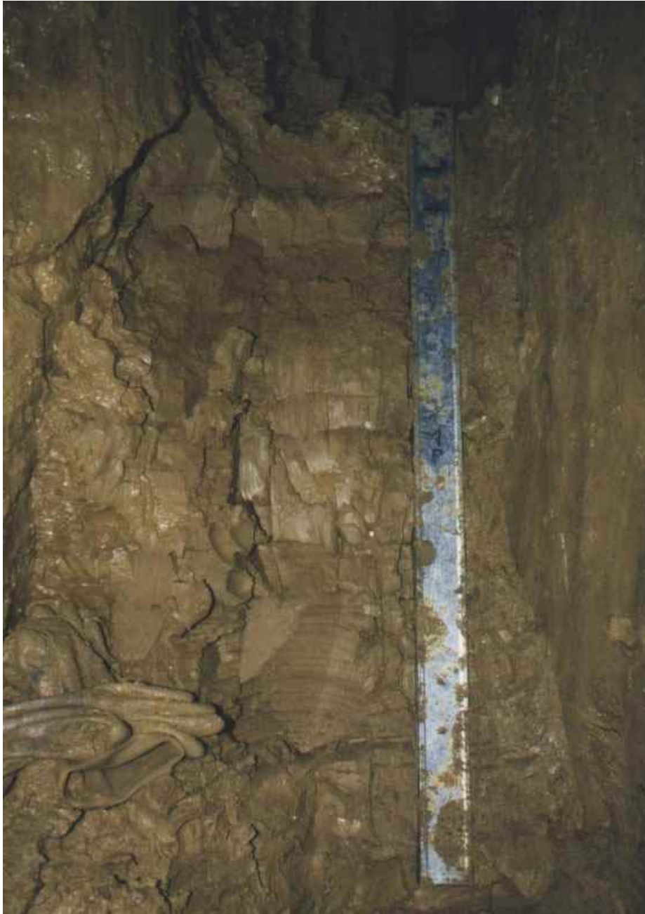
Bild 3: Die erste Profilhohlform steckt im Lehm.
