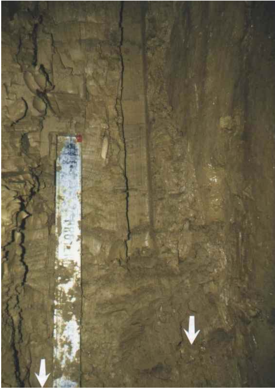
Bild 4: Die erste Hohlform ist schon entnommen, so daß man die feine Schichtung des Lehmsediments dahinter erkennt. Die Pfeile zeigen den Grenzverlauf zwischen geschichtetem Sediment und grober Kluftverfüllung (darunter).
